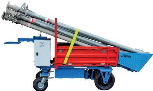
Le Kross Builder 500 est un chariot de manutention électriquement assisté. Il permet de transporter jusqu'à 500 kg de charge sans effort pour l'utilisateur. Il suffit de saisir la poignée pour activer l'assistance électrique.
